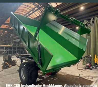
EHK C80 hydraulische Heckklappe, Aluaufsatz einseitig
