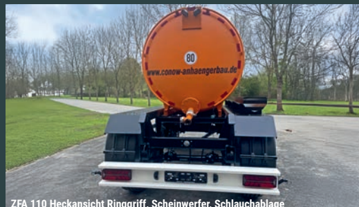
ZFA 110 Heckansicht Ringgriff, Scheinwerfer, Schlauchablage
