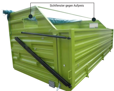
HW 80 Variante 4.2 mit profilierten Bordwänden, Rollplane am Überblaseschutz (Abb. enthält Zusatzausrüstung)
