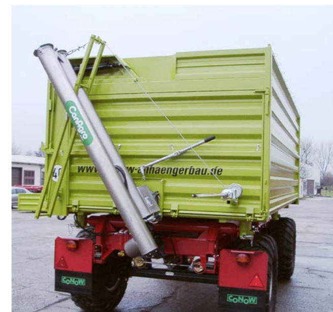
HW 80 Dreiseitenkipper 15 t mit Anbau-Saatgut-Düngerschnecke in Transportstellung
