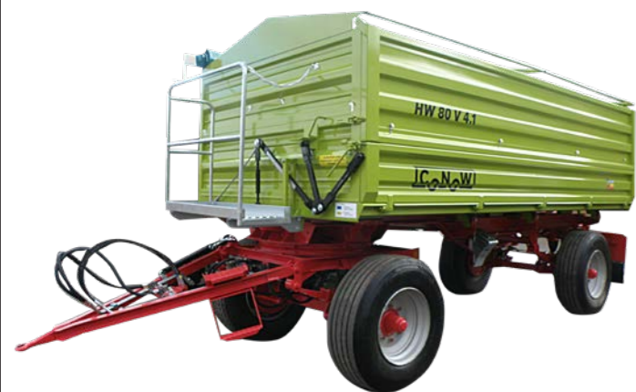
HW 80 Variante 4.1 ringsum mit profilierten, laserverschweißten Bordwänden (Abb. enthält Zusatzausrüstung)
