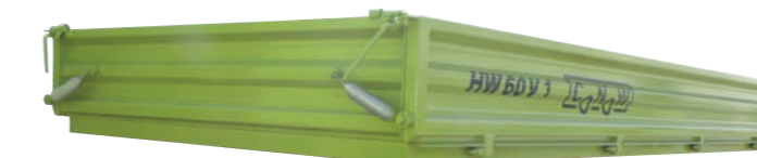
HW 60 mit unteren, profilierten Bordwänden (500 mm) (Abb. enthält Zusatzausrüstung)
