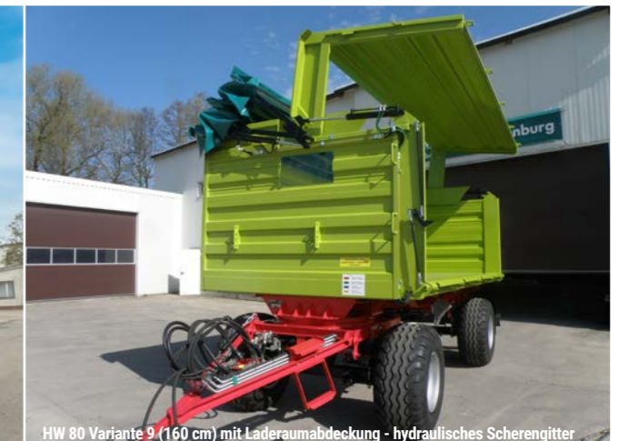
HW 80 Variante 9 (160 cm) mit Laderaumabdeckung - hydraulisches Scherengitter
