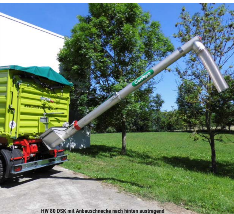
HW 80 DSK mit Anbauschnecke nach hinten austragend
