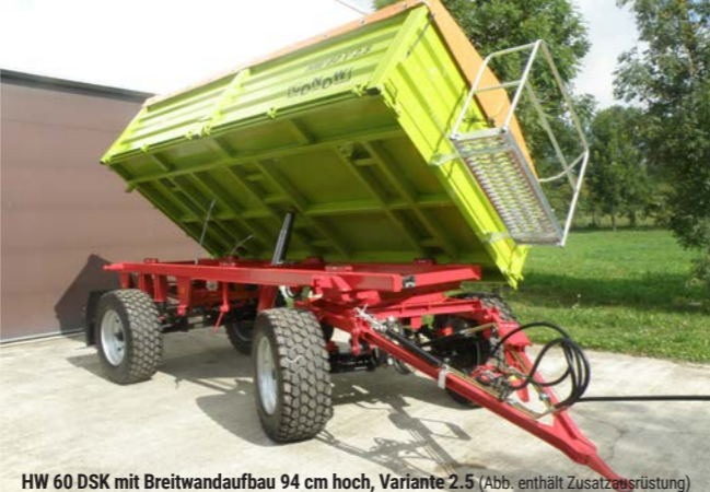
HW 60 DSK mit Breitwandaufbau 94 cm hoch, Variante 2.5 (Abb. enthält Zusatzausrüstung)
