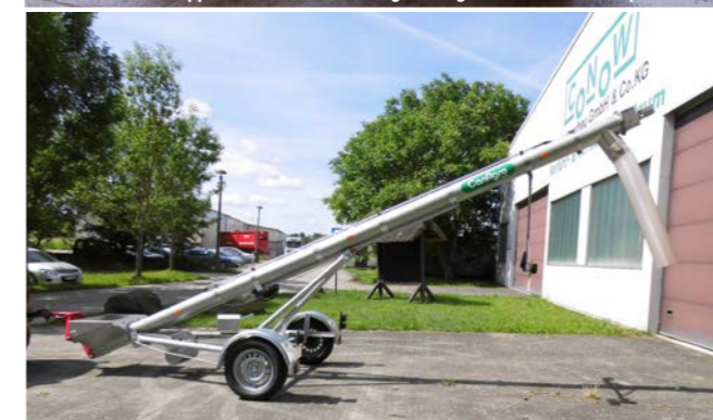
HW 80 Dreiseitenkipper 15 t mit Anbau-Saatgut-Düngerschnecke in Transportstellung
