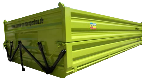
HW 80 mit profilierten laserverschweißten Bordwänden
