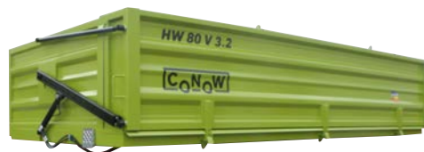
HW 80 Variante 3.2 mit profilierten Bordwänden, hydraulischer Bordwandöffnung (Abb. enthält Zusatzausrüstung)
