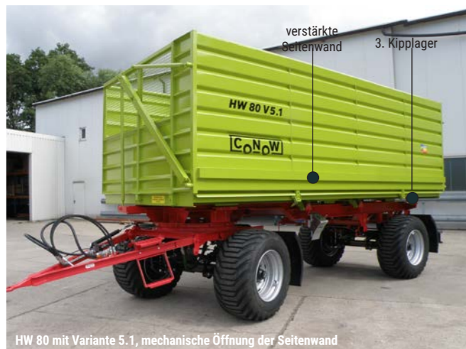
HW 80 mit Variante 5.1, mechanische Öffnung der Seitenwand
