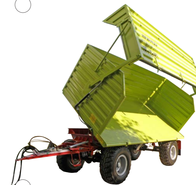
Anhänger mit Aufbau Variante 4.2.3 mit hydraulischer Bordwandöffnung (Abb. enthält Zusatzausrüstung)
