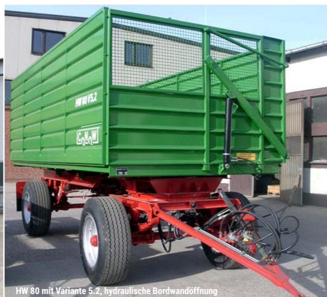
HW 80 mit Variante 5.2, hydraulische Bordwandöffnung
